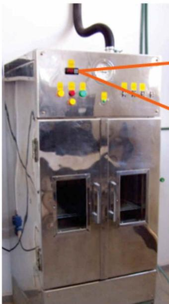
**Figura 1.** Vista de la cámara de carbonatación acelerada.
