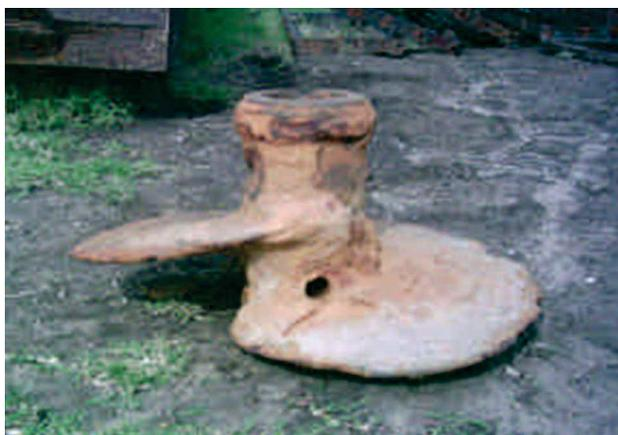
**Figura 2.** Pieza metálica ubicada en el extremo de los parantes que sirve para hincar.
