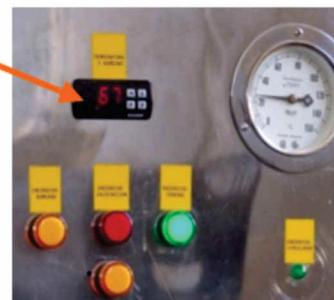
**Figura 2.** Detalle del programador y registro continuo digital de la temperatura y humedad relativa del interior de la cámara.
