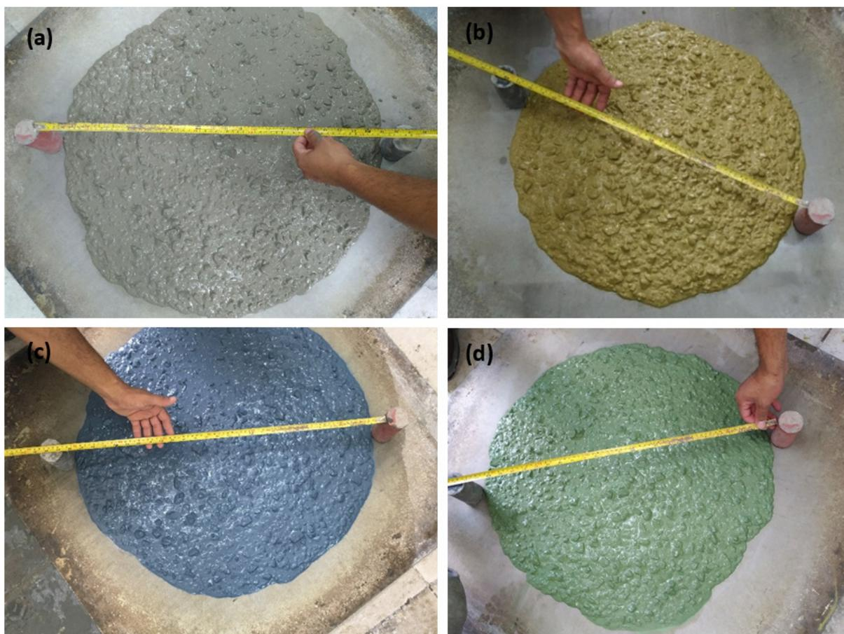
Figura 7. Método del cono de Abrams de la mezcla de concreto: (a) referencia, (b) amarillo pigmentado, (c) azul pigmentado y (d) verde pigmentado. Fuente: Archivo del Grupo de Concreto Pigmentado de la FAU-USP.
