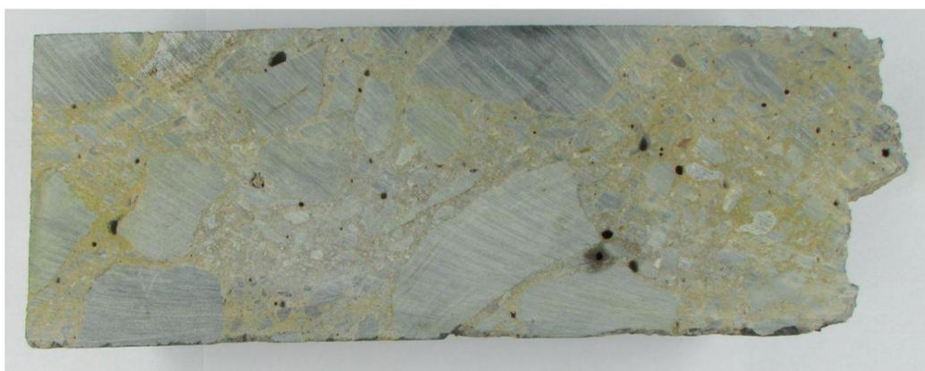
**Figura 4.1** Tinción asociada a la RAA. Diferencia de coloración amarilla a lo largo de la muestra. Fuente: los autores.
