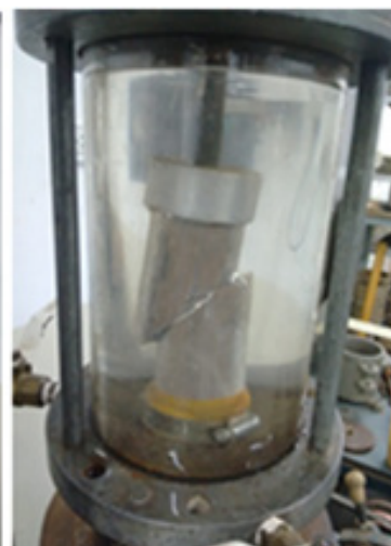
Figura 19. Cámara Triaxial, Prensa de Ensayo y Muestra en Rotura.
