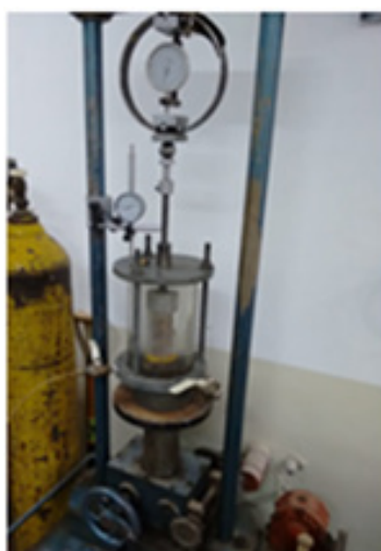
Figura 19. Cámara Triaxial, Prensa de Ensayo y Muestra en Rotura.
