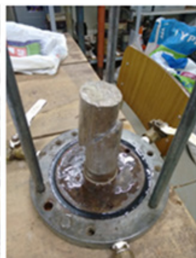
Figura 19. Cámara Triaxial, Prensa de Ensayo y Muestra en Rotura.
