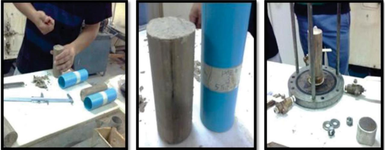
**Figuras 2, 3 y 4.** Preparación de la probeta, verificación de paralelismo entre sus caras y posterior armado sobre el cabezal de la cámara.
