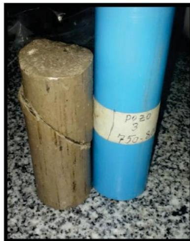
Figuras 9 y 10. Probeta luego de ensayada recubierta en látex y presentando la rotura a 45° por esfuerzos de corte.
