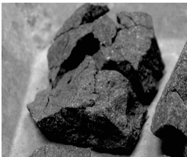
**Figura 8.** Muestra fisurada a 90 días. Primer ángulo.
