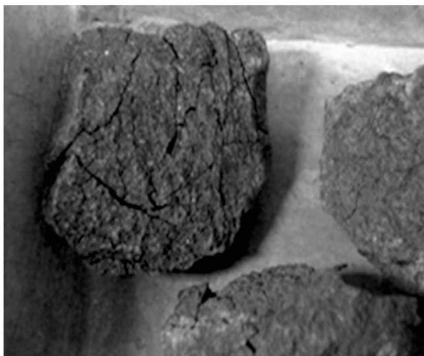
**Figura 4.** Muestra fisurada a 30 días. Primer ángulo.
