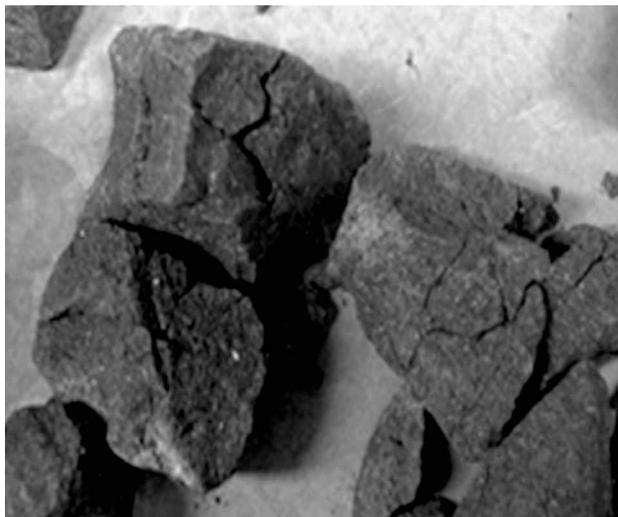
**Figura 6.** Muestra fisurada a 45 días. Primer ángulo.
