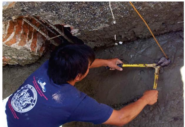
**Figuras 4 y 5.** Colocación de sensores.
