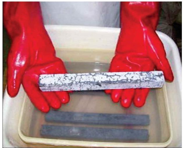
**Figuras 3.** Fisuración en la barra de mortero.
